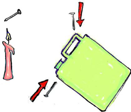
4. CHAUFFEZ LE CLOU AVEC LA BOUGIE ET FAITES DEUX TROUS DANS LE BIDON
